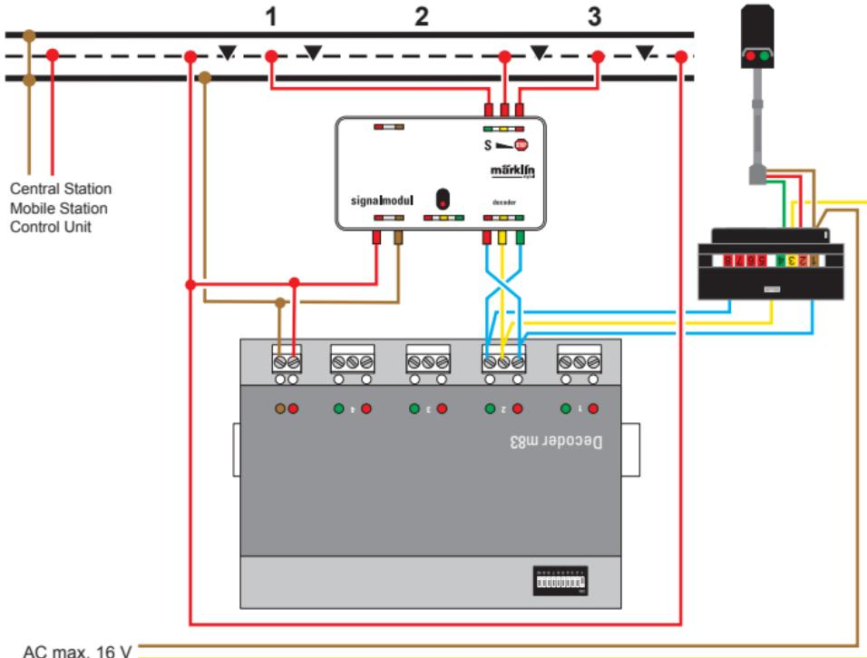
H0: Commande digitale d'article électromagnétique/signal lumineux avec moteur
