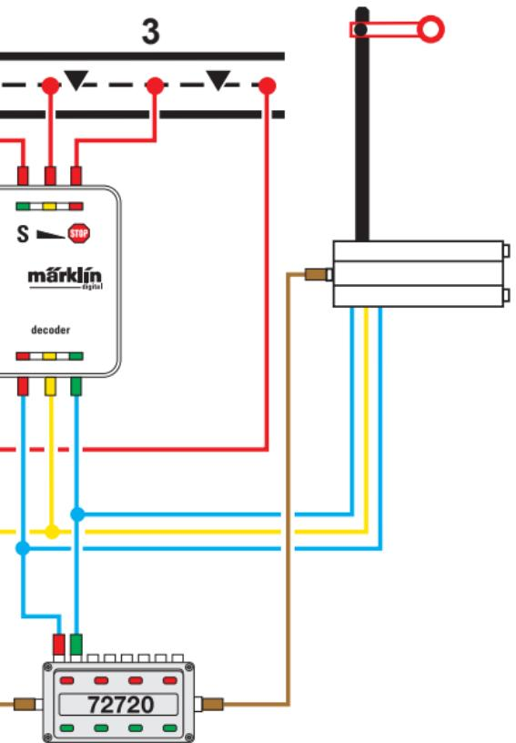
H0: Digitale Magnetartikelsteuerung/Lichtsignal mit Antrieb
