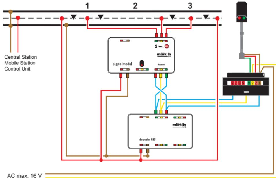
**Spur 1:** Konventionelle Magnetartikelsteuerung/Lichtsignal ohne Antrieb
