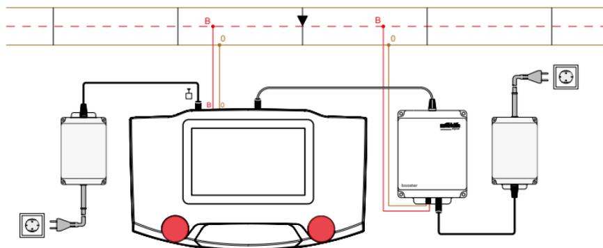
Si desea utilizar boosters 60175 adicionales junto con la Central Station, puede interconectar el terminal 60125/60145 a la Central Station y conectar hasta cuatro boosters por cada terminal.
