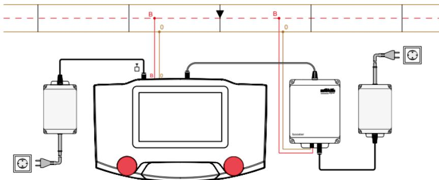
Önskar man koppla in flera Boosterar 60175 till Central Station, så kan man koppla en eller flera Terminal 60125/60145 till Central Station och till varje Terminal 60125 anluta upp till fyra Boosterar.
