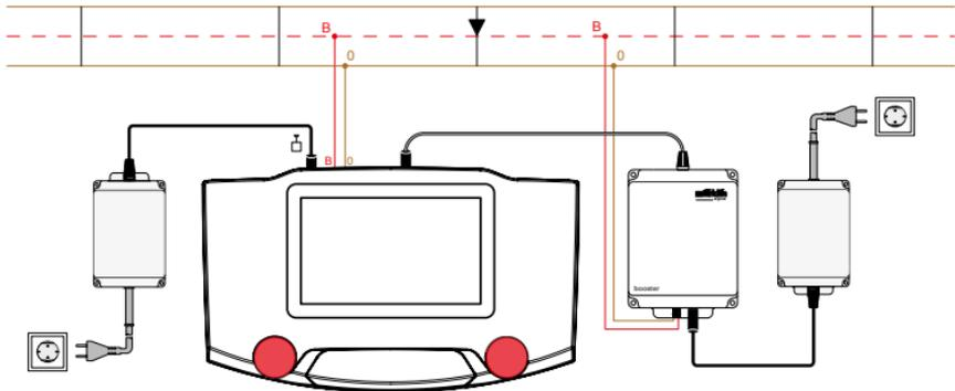
Als u meerdere boosters 60175 op het Central Station wilt aansluiten, dan kunt u de terminal 60125/60145 met het Central Station verbinden en daar de boosters op aansluiten. Op elke terminal kunnen maximaal vier boosters aangesloten worden.
