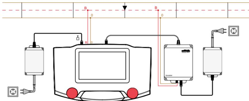
Si vous souhaitez utiliser d'autres boosters 60175 avec la Central station, vous pouvez raccorder le terminal 60125/60145 à la Central Station et relier jusqu'à quatre boosters à chaque terminal.
