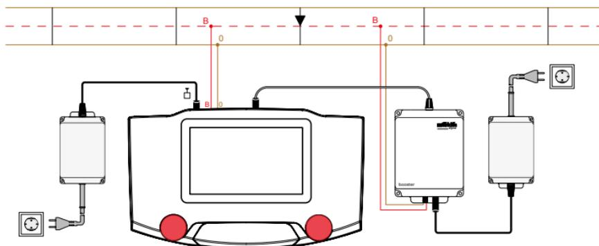
Wenn Sie weitere Booster 60175 mit der Central Station betreiben wollen, so können Sie das Terminal 60125/60145 mit der Central Station verbinden und je Terminal bis zu vier Booster anschließen.
